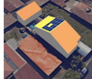
Cubatão 0070 – Gerador Fotovoltaico de 6,9 kWp (aprox. 640 kWh/mês)
