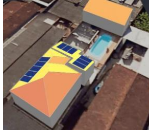
Praia Grande 0064 – Gerador Fotovoltaico de 5,885 kWp (aprox. 570 kWh /mês)
